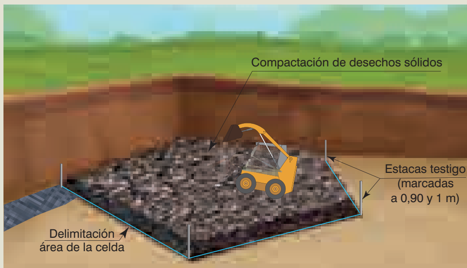
Gráfico 29 Compactación de residuos en la celda
