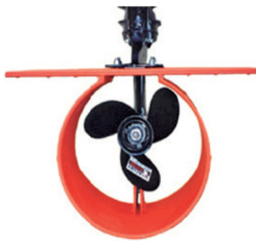
Figura 24. Modelos de protectores para hélice que evitan daños a las tortugas marinas (Choi & Eckert, 2005).
