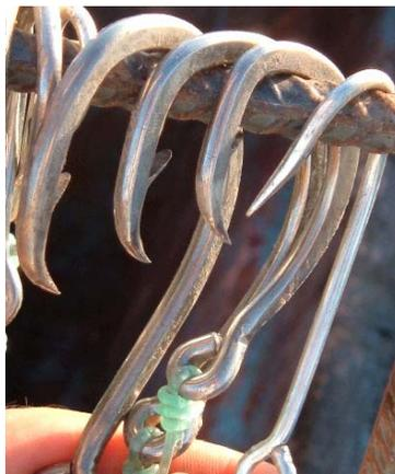
Fig. 5. Anzuelos utilizados en el experimento. De izquierda a derecha: Circular 18/0, circular 16/0, circular 14/0 y tipo "J".
