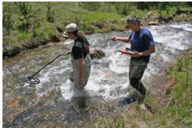
Фигура 33. Проследяване на движението на риби с имплантирани пасивни интегрирани транспондери (PIT) чрез мобилна антена (р. Палакария, Проект: „Възстановяване на популацията на главоча ( Cottus gobio ) на територията на Природен парк „Витоша“, 2015,)
