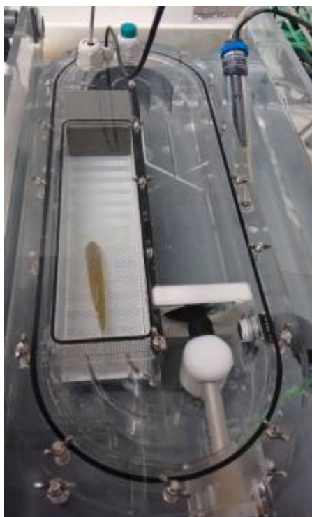
Фигура 10. Експериментална установка за тестване на плавателните възможности на риби (в случая речен кефал) и калибриране на скоростта на водата с ръчен дигитален флоуметър
