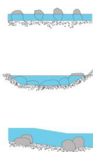
Фигура 21. Типове оформление на дъния субстрат на рампа (план и разрези)
