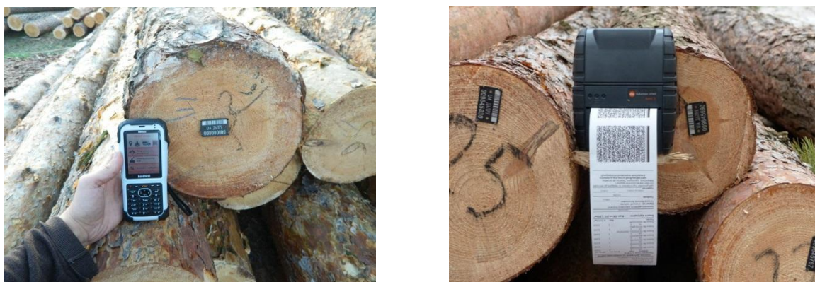
Рис. 9. Мобільний пристрій, бирки із штрих-кодами та мобільна міні-друкарка
