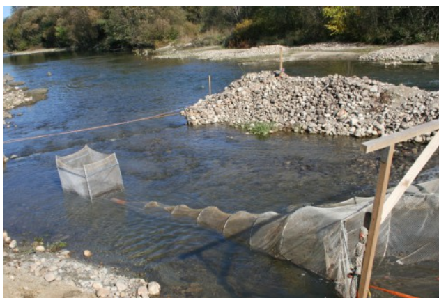
Фигура 31. Мрежени капани на входа на рибен проход с цел установяване миграция на риби (р. Искър, Проект NYLOW, 2011)
