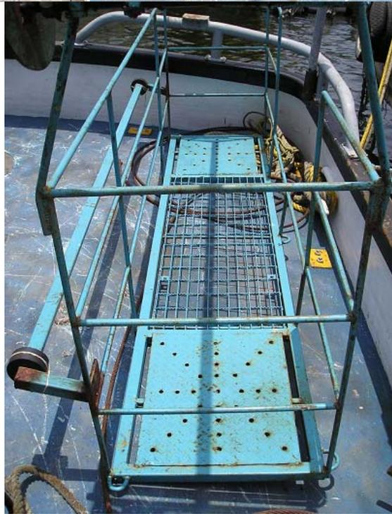
Fig. 11. Camilla construida para facilitar la colocación de marcas SPOT-4 a bordo del B/I UNICAP XVI del INP (Foto: Abraham Avilés, INP)
