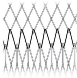
Para unir una pieza de 150 mallas con una de 300 mallas de ancho, se deberán agarrar dos mallas de la pieza más grande con una malla de la pieza más chica, como se muestra en la figura.
