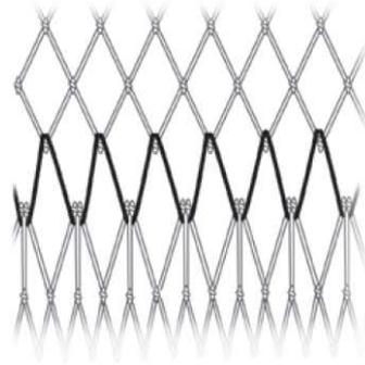
**4** Unión del tercer anillo con la falda: la unión de estas secciones sólo se realizará con trescientas mallas de la falda, pegando con trescientas mallas de la falda, quedando sin pegar las otras trescientas, iniciando a pegar desde el extremo de la falda.
