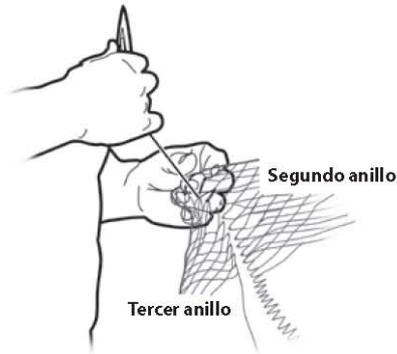
Para unir una pieza de 300 mallas con una de 600 mallas de ancho, se deberán unir dos mallas de la pieza más grande con una malla de la pieza más chica.
