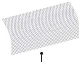
Una pieza de paño nylon monofilamento de 47 mm de diámetro y tamaño de malla de 35 mm, con dimensiones de 650 x 75 mallas.
