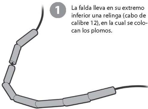
**1** La falda lleva en su extremo inferior una relinga (cabo de calibre 12), en la cual se colocan los plomos.
